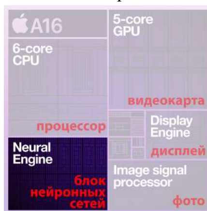
Рисунок 4 – Схема процессора смартфона iPhone
